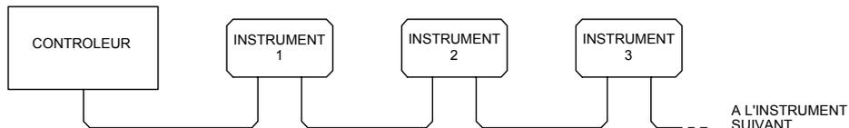
La chaîne en guirlande est constituée des lignes de données de transmission (TXD), de réception (RXD) et des lignes de terre de signaux uniquement. Il n'y a pas de lignes de commande/établissement de liaison. Ceci rend essentiel le protocole XON/XOFF et permet à l'interconnexion entre les instruments de contenir juste 3 fils. Le câblage du câble de l'adaptateur est indiqué ci-dessous.
