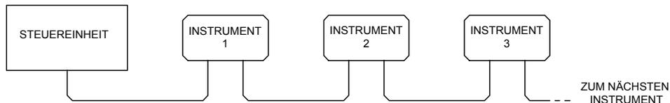
Die Verkettung besteht lediglich aus Übertragungsdaten- (TXD), Empfangsdaten (RXD) und Nullsignal-Leitungen. Es gibt keine Steuer/Handshaking-Leitungen. Somit ist XON/XOFF-Protokoll erforderlich und es ist dabei möglich, daß die Verbindung zwischen Instrumenten lediglich drei Adern beinhaltet. Der Anschluß des Adapterkabels ist aus folgender Darstellung ersichtlich.
